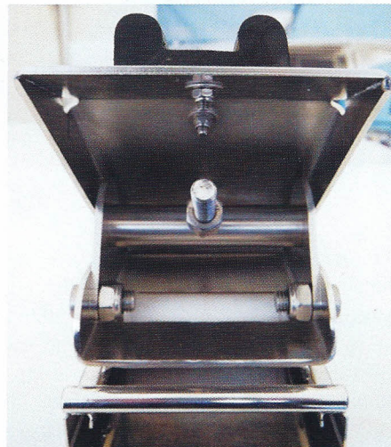
Die Neigung der Auflager lässt sich einfach einstellen.
